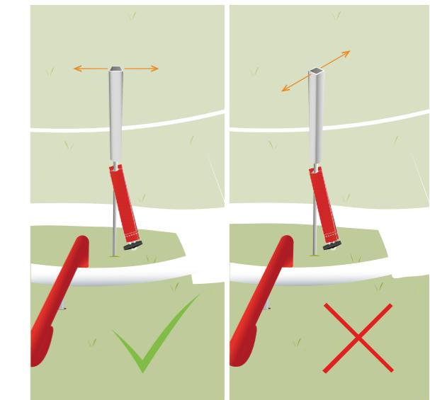
**NL:** Plaats de grondbus in de juiste positie zoals aangegeven. Sla vervolgens de grondbus verder in de grond totdat deze gelijk aan de grond ligt. Hierna sla je de grondbus aan de achterzijde van de SunnyTent op dezelfde wijze de grond in.
