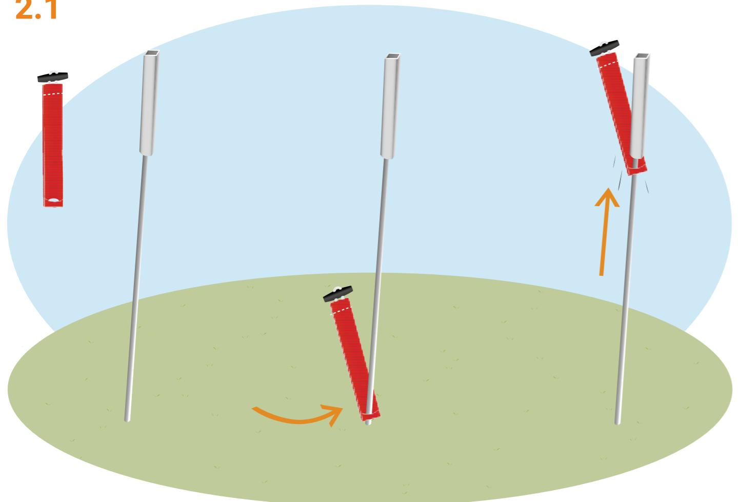
**NL:** De rode koppelgesp moet via de onderzijde over de grondbus geschoven worden voor hij in de grond wordt geplaatst.
