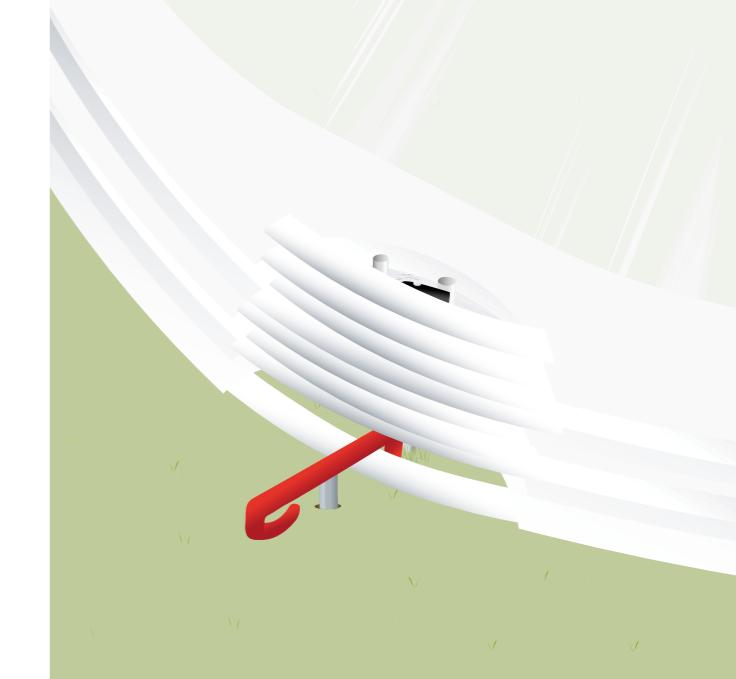
**NL:** Aan de **achterzijde** pak je nu de tentbanen op waarna je de verbindingsvork in de grondbuis plaatst. Begeleid nu vervolgens de tentbanen stuk voor stuk over de verbindingsvork tot aan de grond. De verbindingsvork gaat door de opening van alle stokkentunnels.
