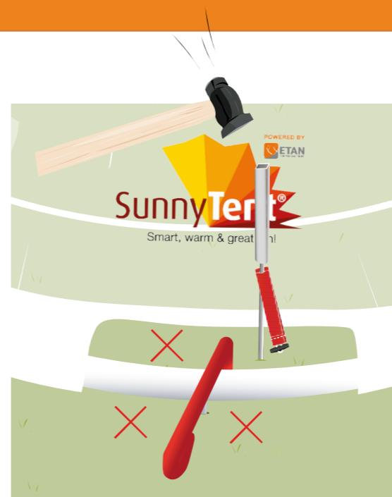
**NL:** Om de dwarsstokkenset vast te zetten, ga je nu de twee grondbuizen in de grond plaatsen. Eén gaat aan de voorzijde, en één aan de achterzijde van de SunnyTent. Deze moeten worden geplaatst bij de middelste draaiharing.
